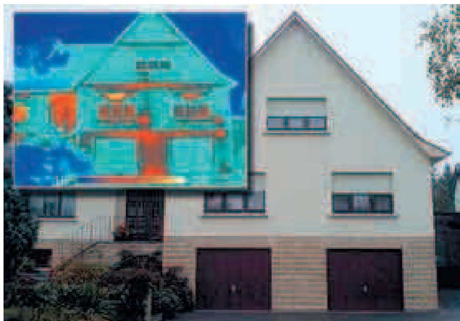
Fotografía 1. Termografía e imagen real de vivienda unifamiliar. Fuente: Flir España.
